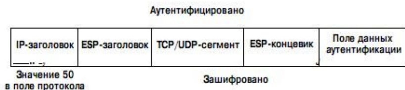
Рис. 7.34. Поля протокола ESP в IP-дейтаграмме
