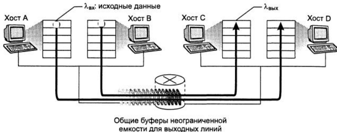
Рис. 3.38. Ситуация 1: два соединения совместно используют маршрутизатор с буферами неограниченной емкости
