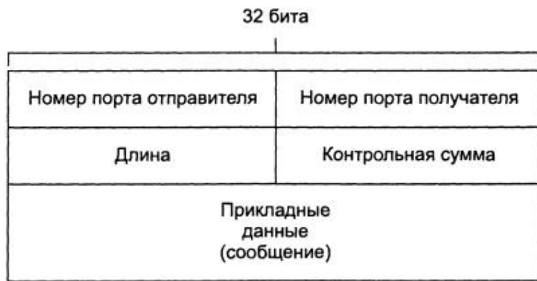
Рис. 3.6. Структура UDP-сегмента
