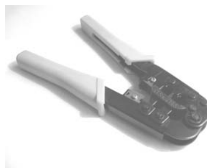
Рисунок 5. Ножницы для обжима разъемов RJ45, RJ11
